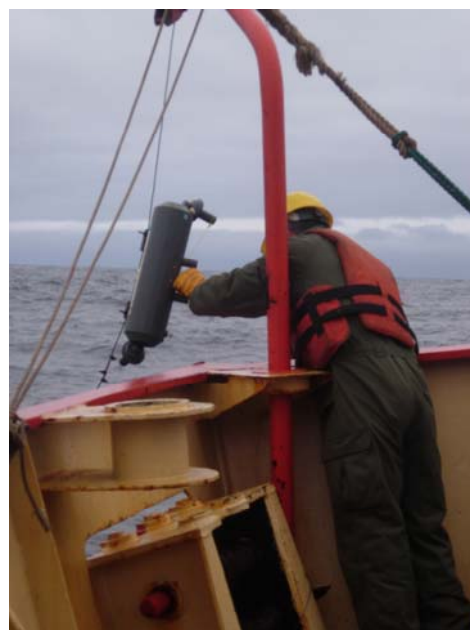
Figura 4. Guinche oceanográfico (izq.) y maniobra de casting con botellas Niskin (der.)
