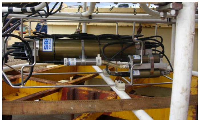
Figura 2: Roseta con botellas utilizada (izq.). Detalle de la configuración de sensores en el CTD (motaje horizontal, der).
