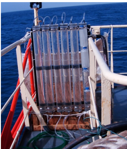
Figura 4. Incubador para experiencias de incorporación de ^{15}\text{N} .
