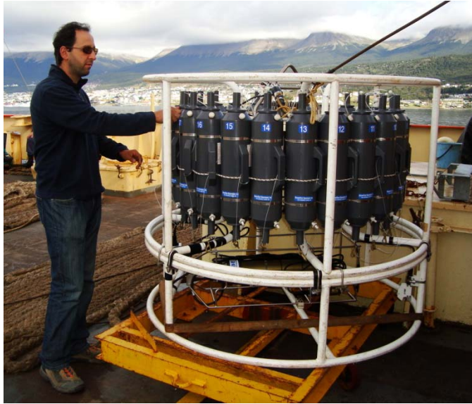
Figura 2: Equipo CTD y roseta de botellas Niskin.
