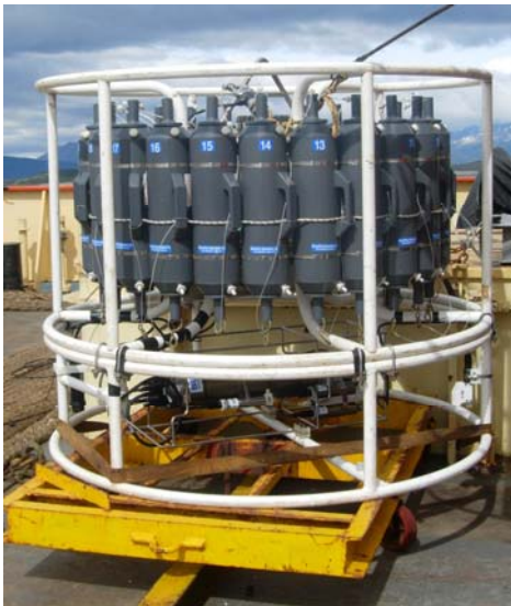
Figura 2: Roseta con botellas utilizada (izq.). Detalle de la configuración de sensores en el CTD (motaje horizontal, der).
