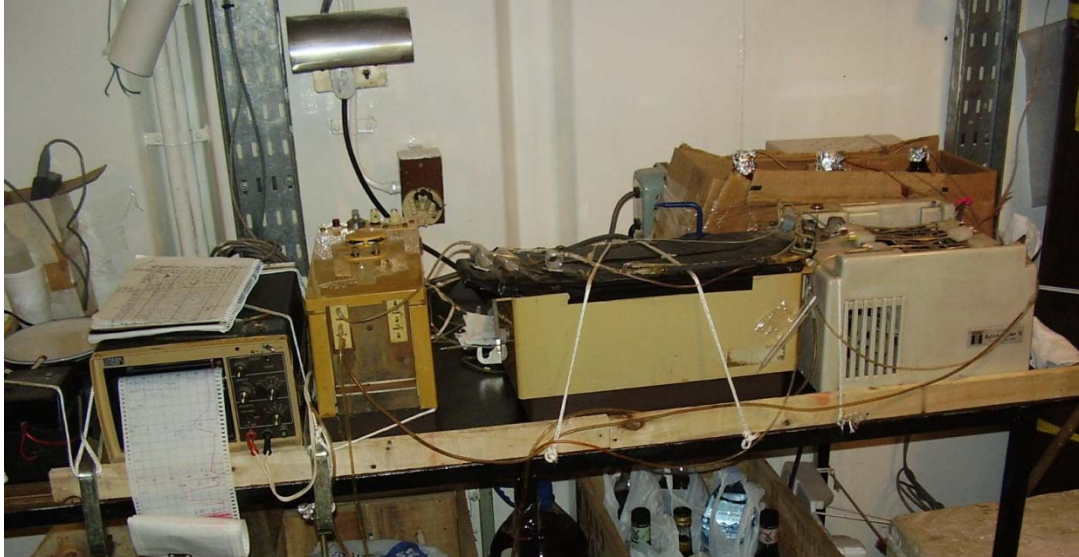
Figura 3. Autoanalizador para muestreo continuo de nitrato.
