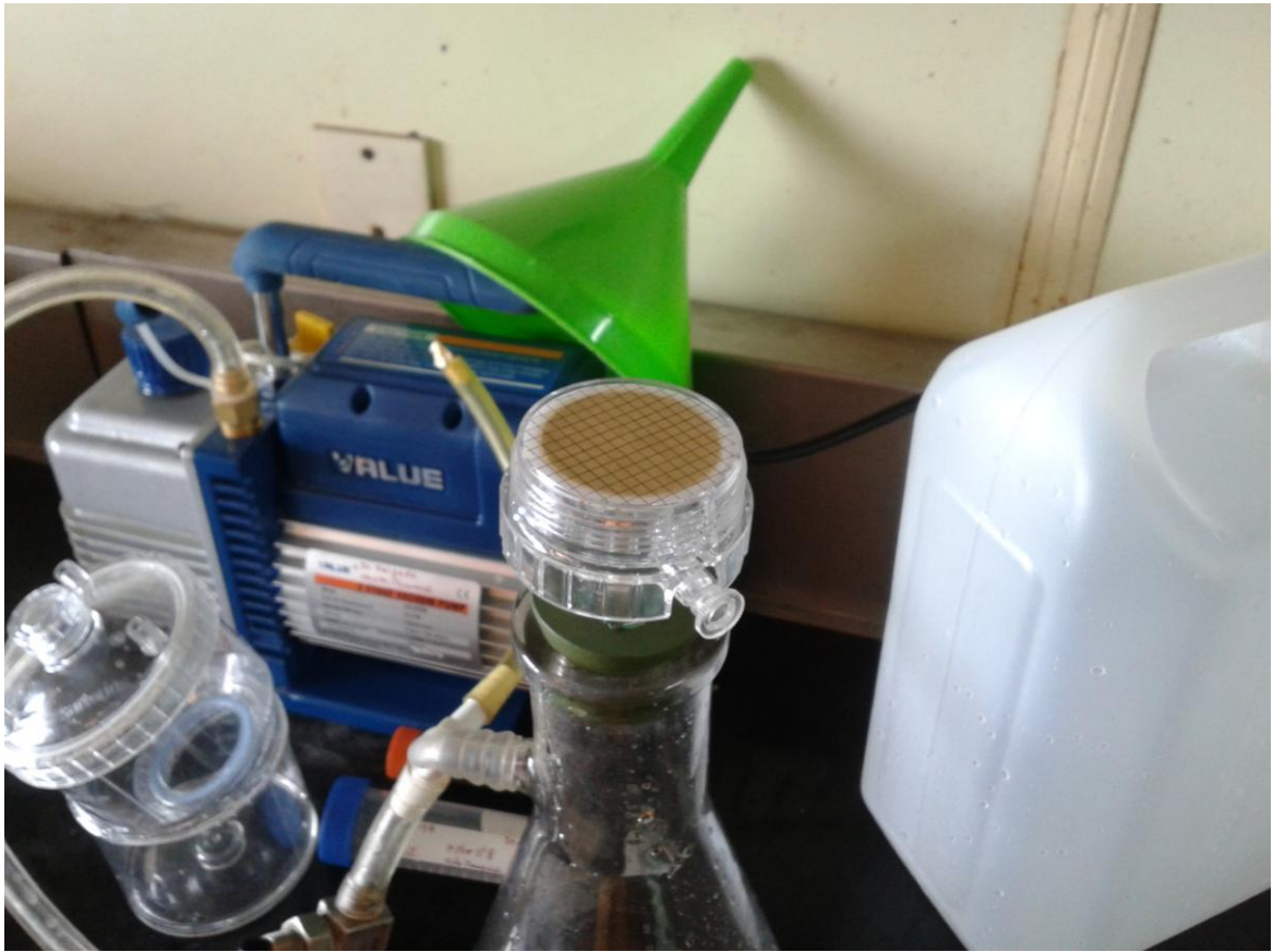
Figura 1: Detalle del equipo de filtración. Se puede observar material que queda en un filtro con poros de 0,8 micrómetros, tras filtrar 5 litros de agua de superficie.
